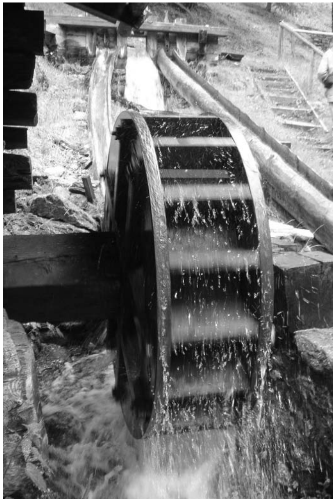
Das unterschlächtige Zellenrad der Stoffwalke in Aktion.
