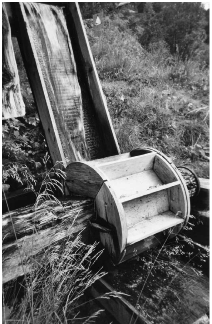
hinterschlächtiger Schnellläufer (oder Waschel)
