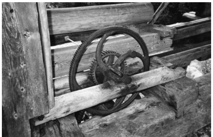
Vorschubgetriebe mit Handkurbel für den Wagenrück Schub. Unterhalb des Blockwagens befindet sich eine Holztrommel. Um diese Trommel war ein Seil gewickelt, das den Wagen vorwärtsbewegte.
