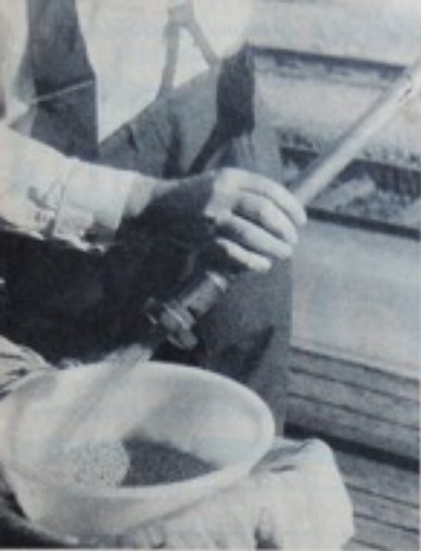
Links: Ein wichtiges und vorgeschriebenes Instrument ist die Sonde. Mit dieser sticht der Aufkäufer bis auf den Grund des Sackes, schreibt sie zu und erhält so eine Durchchnittsprobe.
