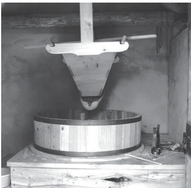
Abb. 33 Typischer Kastanien-Mahlgang. Diese Anlage steht in Brontallo.
