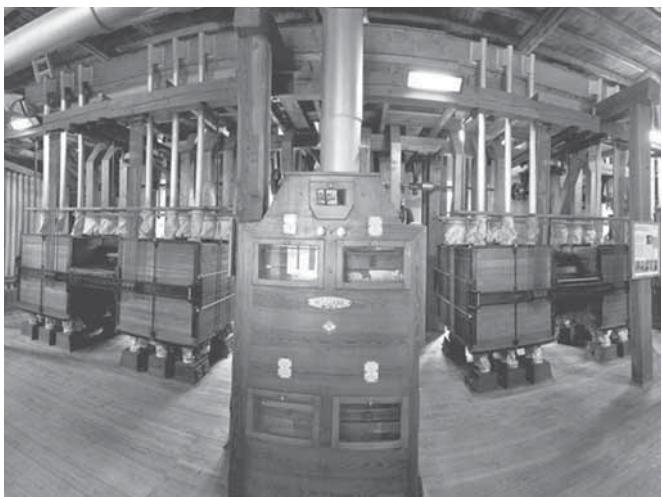
Abb. 14 Plansichter der italienischen Firma Officine Meccaniche Italiane aus dem Jahre 1895, in der Mitte die Griessputzmaschinen
