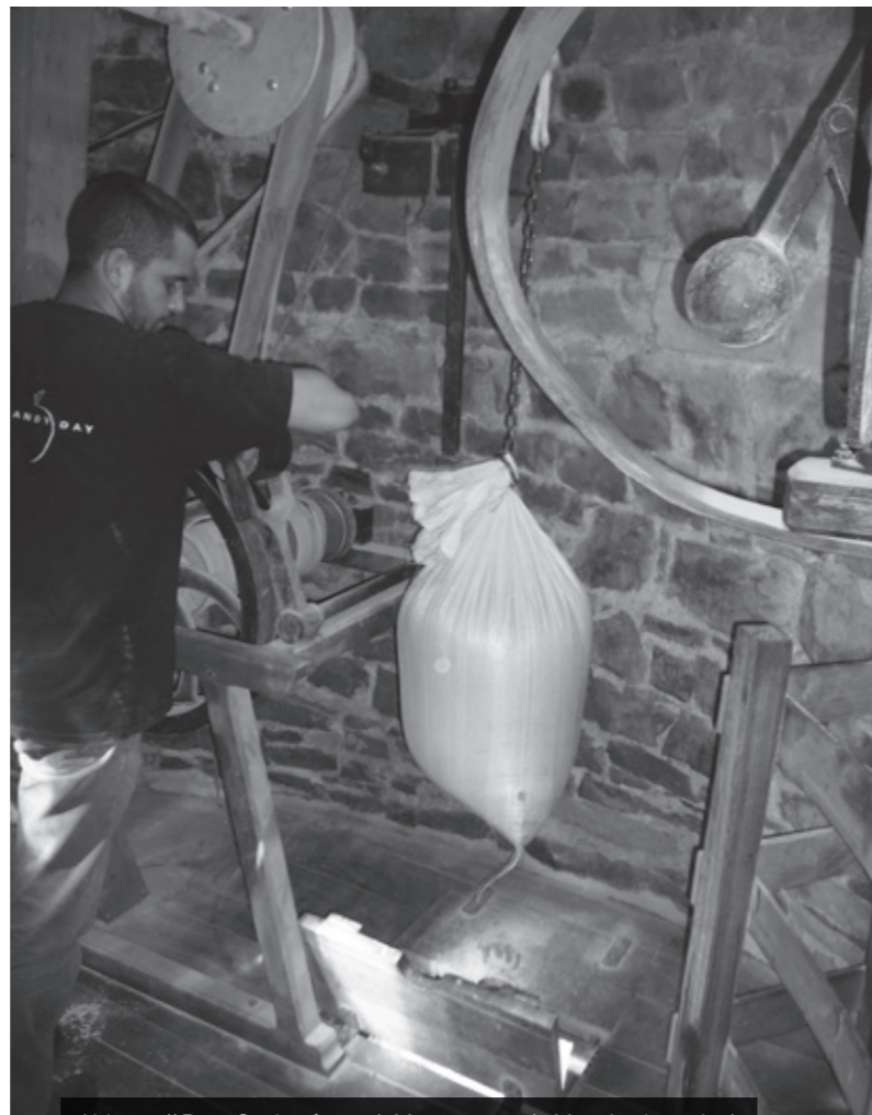
Abb. 13 // Der «Sackaufzug» («Monte sacs» / «Montée du grain») der Turmwindmühle von Cotentin in Fierville-les-Mines. Die Klappen, die von den Säcken auf ihrem Weg nach oben geöffnet werden, fallen wieder von alleine zu.
