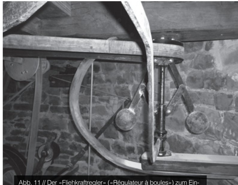
Abb. 11 // Der «Fliehkraftregler» («Régulateur à boules») zum Einstellen der Kornzufuhr beziehungsweise der Drehgeschwindigkeit der Windflügel der Turmwindmühle von Cotentin in Fierville-les-Mines.
