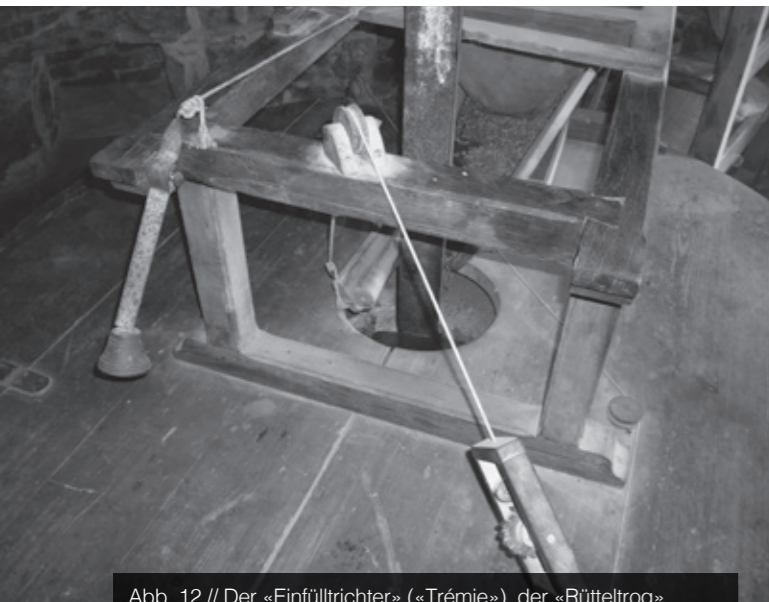
Abb. 12 // Der «Einfülltrichter» («Trémie»), der «Rütteltrog» («L'auget»), der «Ochsenknochen» («Babillard», «Babillard ou demiselle») und das Warnglöckchen
