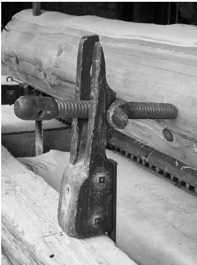
Abb. 5. Mit dem ‚Wagenknecht‘ werden beim Schnitt lange Bretter gehalten (Densbüren AG).
