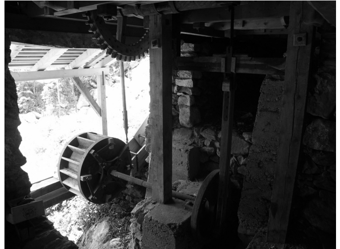
Abb. 3. Einstelzer mit Kurbelscheibe und Walzenrad (Mühletal bei Innerkirchen BE).
