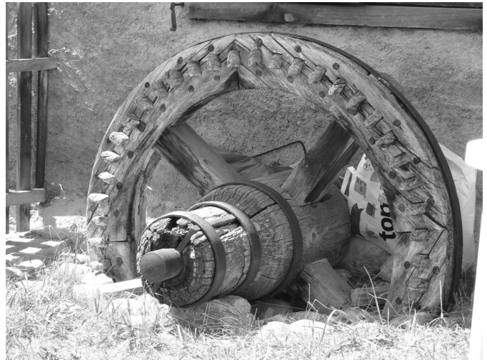
Hölzernes Kammrad mit Wellbaum einer abgegangenen Mühle in Lohn GR. Foto: A. Schürch. (Symbolbild!)
