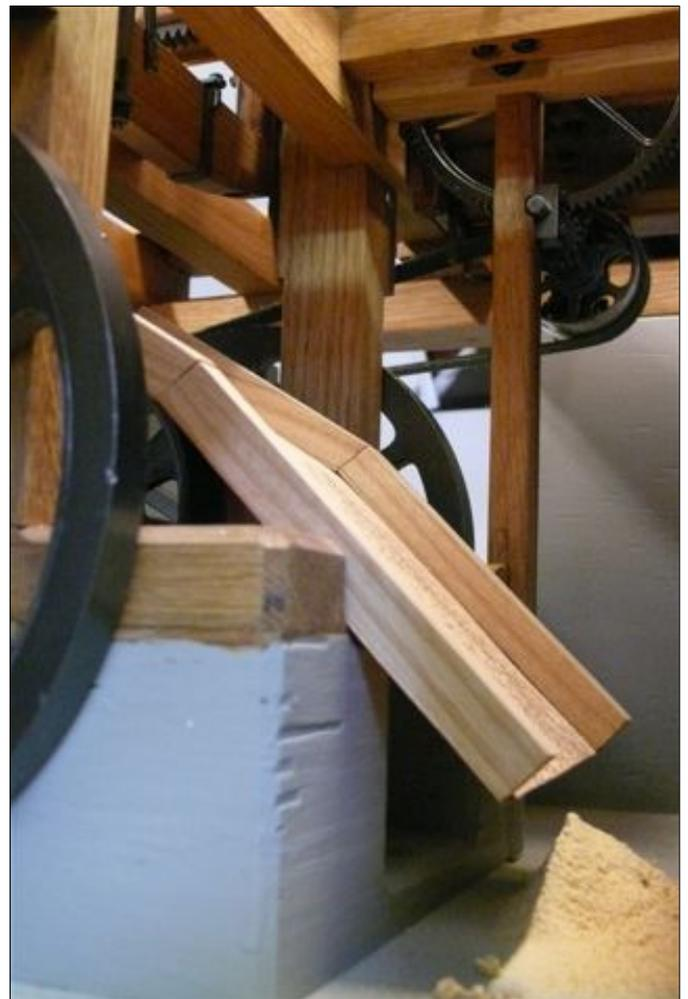
*Modell-Impressionen von der Sägemühle Heimenhausen. Gegenüberliegende Seite: Das grosse Modell misst über 3 Meter in der Länge. Oben: Blick auf die Transmission im Gatterkeller. Links: Vorschubmechanismus. Rechts: Säge-spänerutsche und echtes Modell-Sägemehl.*
