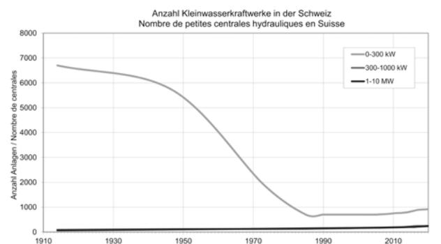
Abb. 2 Anzahl Kleinwasserkraftwerke in der Schweiz über die letzten 100 Jahre. Quelle: <https://swissmallhydro.ch/wp-content/uploads/2020/07/Factsheet-Kleinwasserkraft-2020.pdf>
