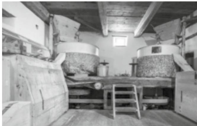
Abb. 18 Mühle Aino aus dem 18. Jahrhundert im Puschlav. Links ein Mahlgang mit Kantsichter, rechts ein Mahlgang für Mais. Hier ist Buchweizen auch schon verarbeitet worden
