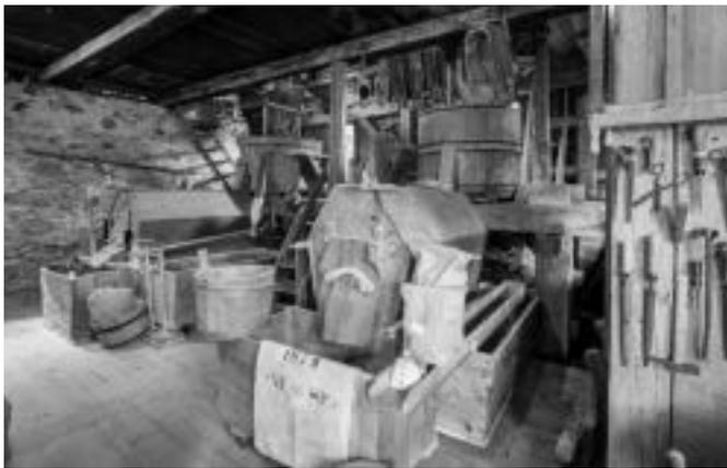
Abb. 4 Alpine Mühle Ftan GR, Mühlen mit vorgelagerten Beutelkasten und Trenneinrichtungen
