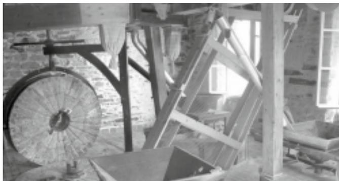
Abb. 20 Le Moulin de la Fatigue in der Bretagne. Rechts der Schäl- mahlgang, links der Mehlmahlgang
