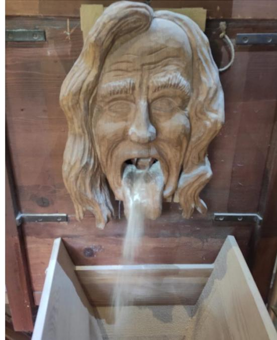
*Eines der frisch renovierten neuen Wasserräder, und der nicht ganz für die Schweiz autochtone Kleiekotzer, welcher gerade Schrot aus einem Sechskantsicher auswürft, welches im Anschluss nochmals in einem Steinmahlgang (rückgeschüttet) zu feinem Vollkornmehl verarbeitet wird.*
