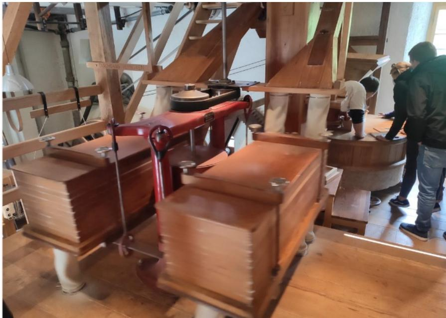
*Urs Wickihalder zeigt im Bild, wie die horizontale Steinmühle mit Korn beschickt wird.*
