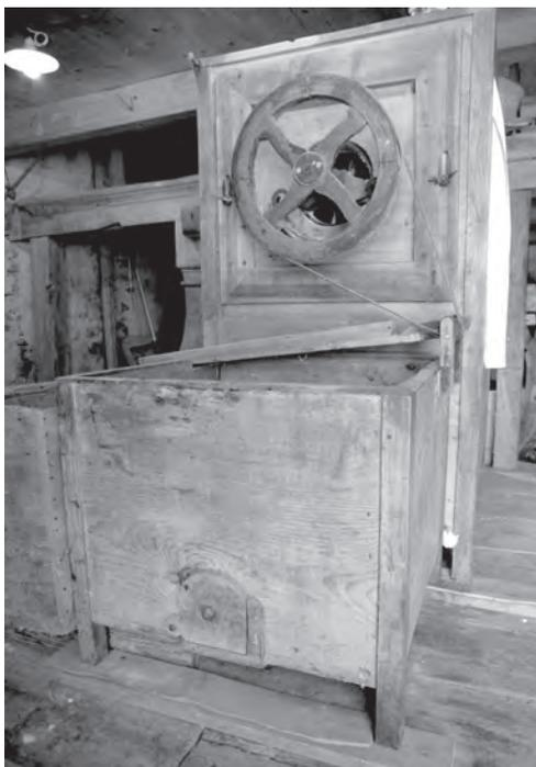
Abb. 24 Der Mehlkasten von vorne mit dem Antriebsrad für den Abräder
