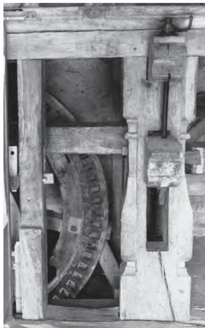
Abb. 21 Hier ein Blick unter den Mahltisch, in der Mitte das grosse Zahnrad, rechts die Bietsäule mit der Stellspindel
