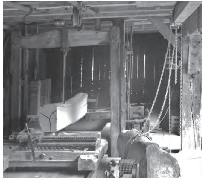
Abb. 32 Das Geleise des Stammwagens bedarf einer „Begradigung“, „gnappt“ doch der Wagen mit dem aufgespannten Stamm genau beim Gatter mit dem eingespannten Sägeblatt ständig auf und ab.
