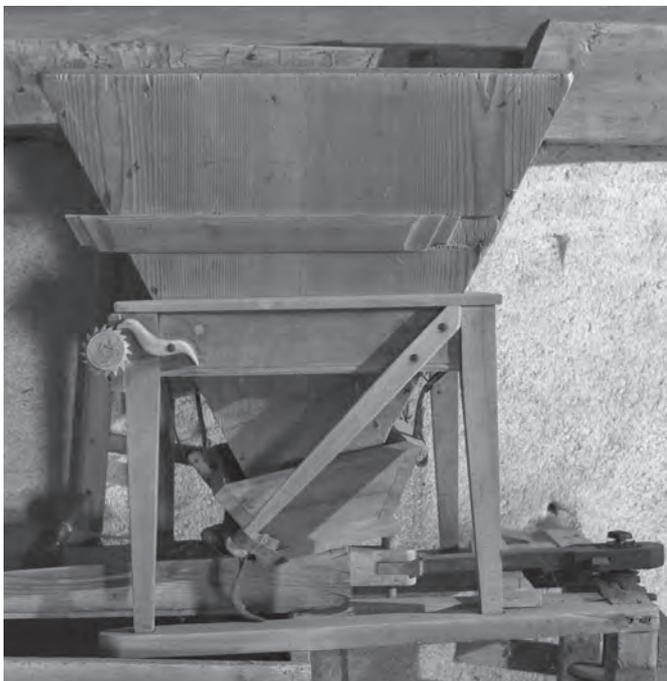
Abb. 23 Der Rüttelstuhl am einten Sieb. Schön ersichtlich ist der geschnitzte Vogel am Stellrad für die Neigung des Rüttelstuhles.
