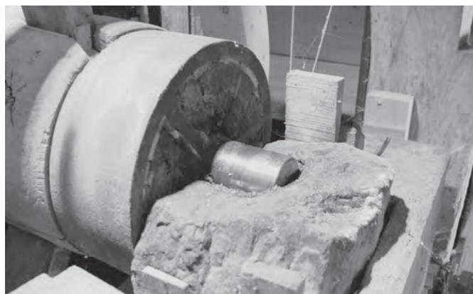
Abb. 18 Hier das Steinlager des Wellbaums unter dem Mahltisch
