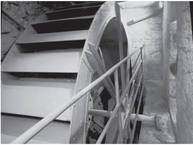
Abb. 33 Um 1997 wurde das Wasserrad aus dem Jahr 1925 durch ein neues aus verzinktem Stahl ersetzt, natürlich mit der Welle und den Lagern.
