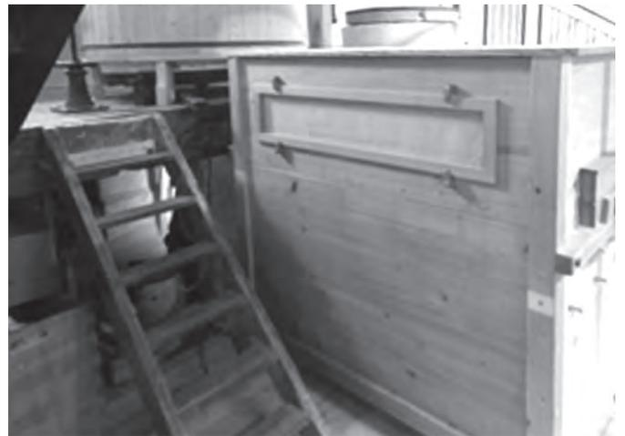
Abb. 28 Am Mahlgang ist ein verkleideter Sechskantsichter angefügt.
