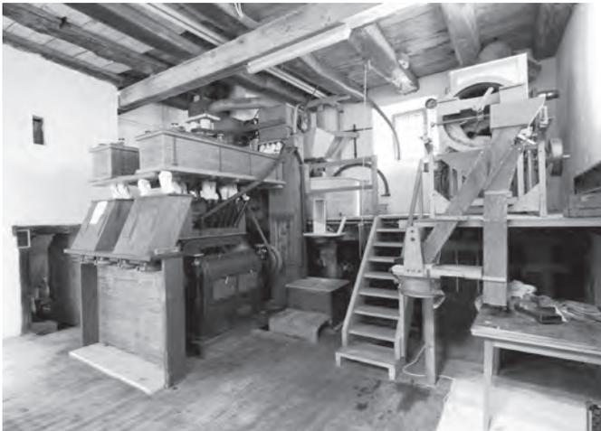
Abb. 34 Abgebildet ist ein wahres Unikum, ein kompletter Meyer Automat, oben der Sichter, hinten der Elevator.
