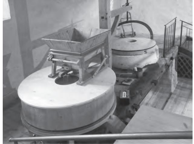
Abb. 27 Ein sauber verkleideter Mahlgang im Hintergrund, nebenan vorbereitet ein Zweiter, ev. eine Relle. Die Relle dient zum Entspelzen, z.B. von Dinkel
