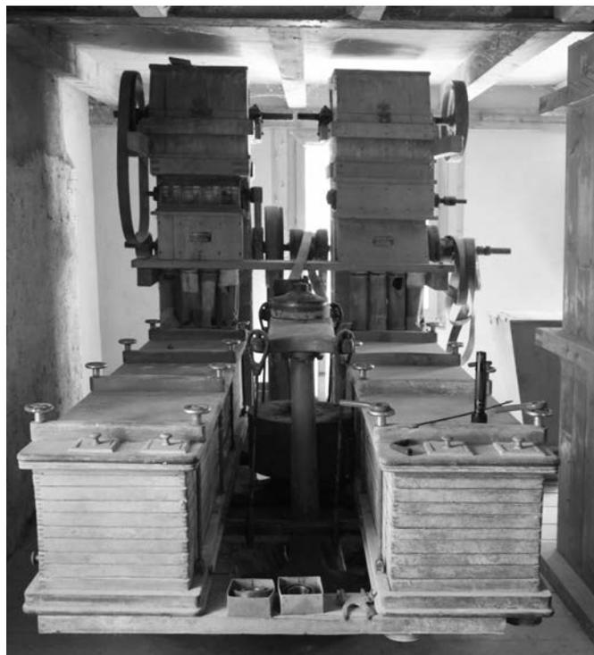
Abb. 22 Le «Plansichter» de O. Meyer & Cie Soleure, à l'arrière-plan les deux élévateurs avec 4 passages
