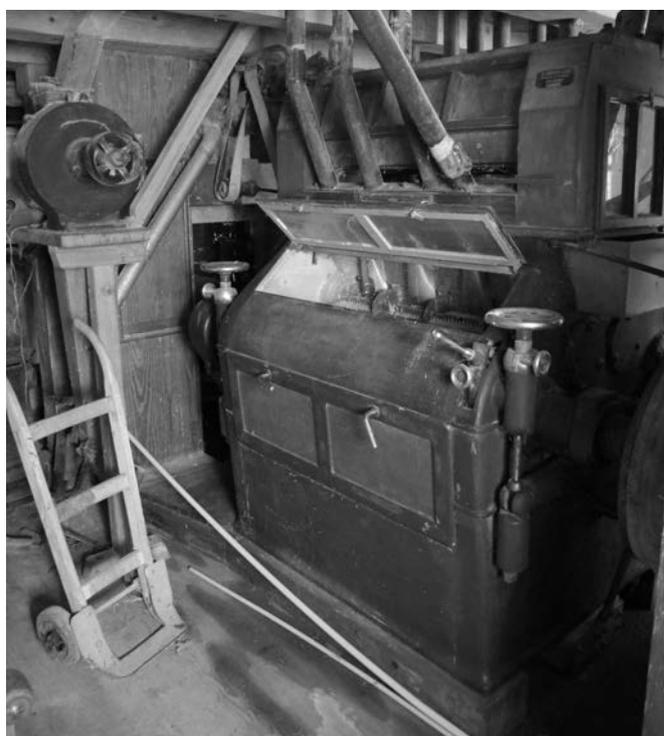
Abb. 26 Pour finir, le broyeur à cylindres, un automate Meyer semblable à celui de Soubey.
