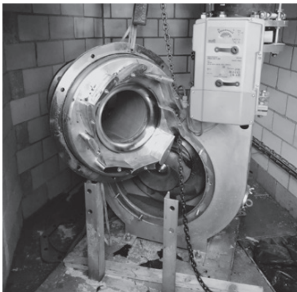
Leitapparat Francisturbine Mikrokraftwerk Obermüli Andelfingen, Anlage Nr. 57
