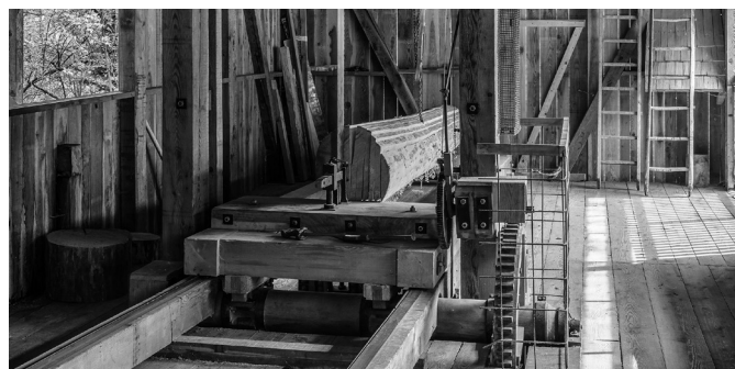
Abb. 1: Sagiraum mit Schlitten und Gatter
