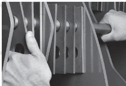
Einfacher Werkzeugwechsel bei Granulex® 3 und Granulex® 5
