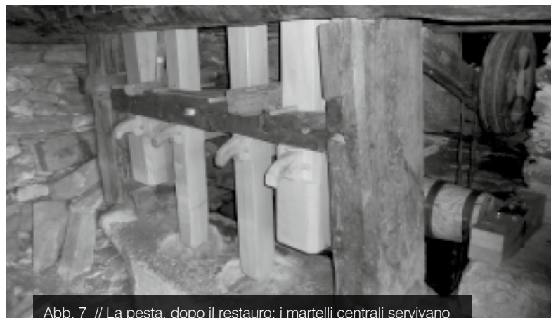
Abb. 7 // La pesta, dopo il restauro: i martelli centrali servono per la brillatura dell'orzo, posto negli incavi del basamento; i martelli laterali, più pesanti, ricadevano invece su un supporto piatto sul quale erano posti i fasci di canapa o lino. (Foto: Archivio APAV, Coglio)
