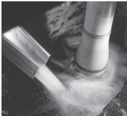
Ruota orizzontale Mulino Efra Frasco Val
