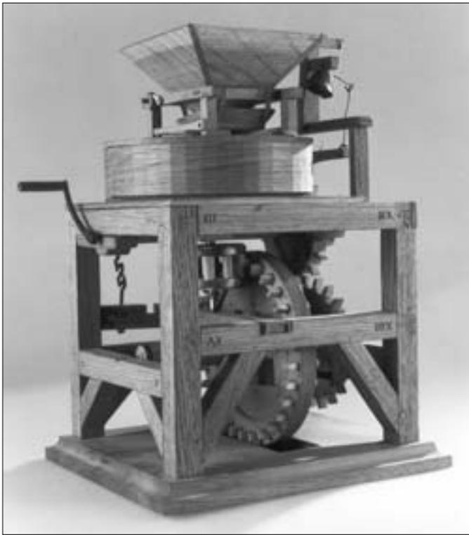
Abb. 2. Die Mahlgangsdrehmühle ist ähnlich wie der Mahl-gang aufgebaut, wird aber von Hand bedient. Modell 1 : 5 gebaut vom Verfasser.
