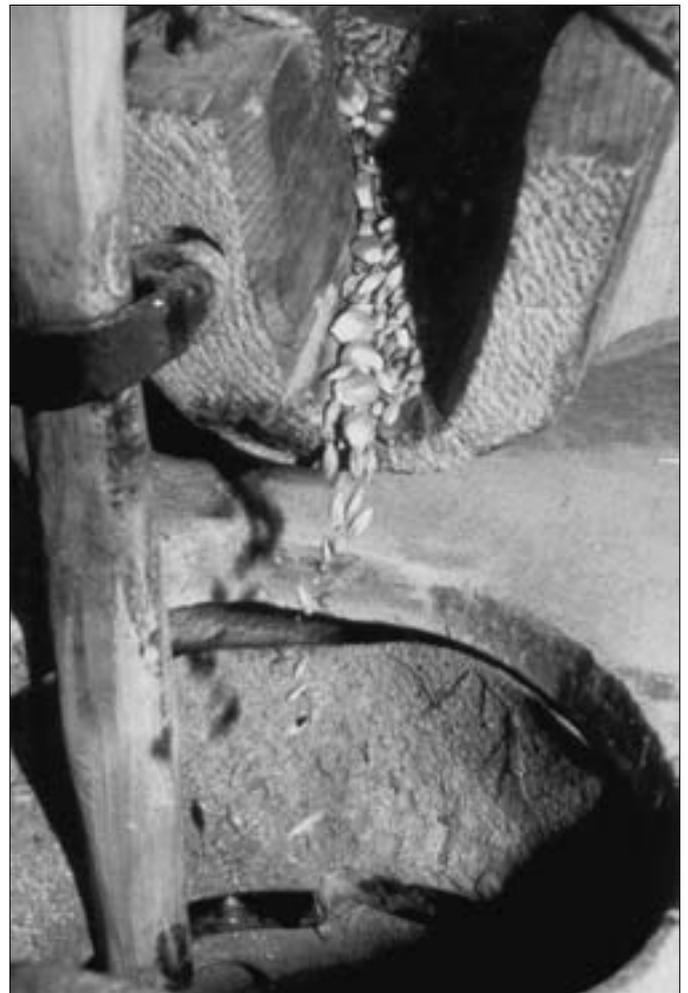
Abb. 3. Der Rüttelschuh ist ein wichtiges Teil des Rumpfzeugs. Er besorgt den fein dosierten Einlauf des Mahlgutes in das Steinauge und wird hier durch den Rüttelstecken bewegt. Im Steinauge ist der Warzenring sichtbar (Stockmühle in Apriach, Kärnten).
